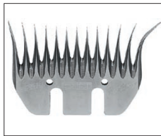
Bild 10: Der meistverwendete Kamm in Australien. Er ist 94,5 mm breit und hat einen langen Spitzenradius, geeignet für feine Merinowolle.
